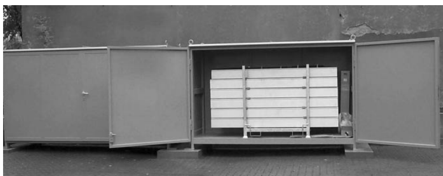
Bild 6: Lagerung des mobilen Dammbalkensystems
